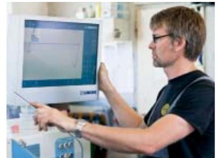
Wenige Augenblicke später in der heimischen Werkstatt: Der Mitarbeiter an der CNC-Maschine öffnet die Profildaten, prüft sie und startet die Profil-Fertigung.
